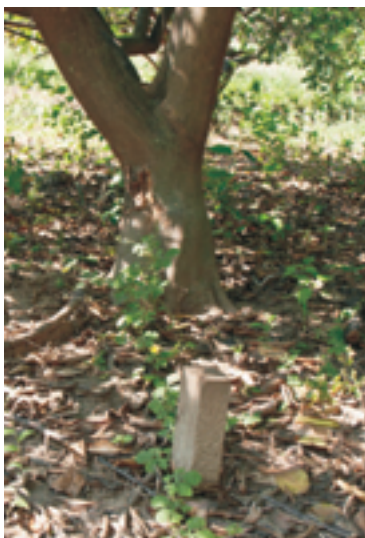
figura 12. Estaca de madera para el monitoreo de termitas en campo.
