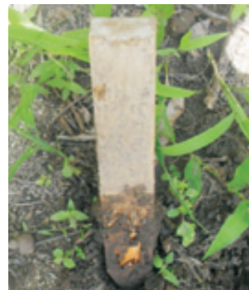
figura 6. Trampas de madera para el monitoreo de termitas.
